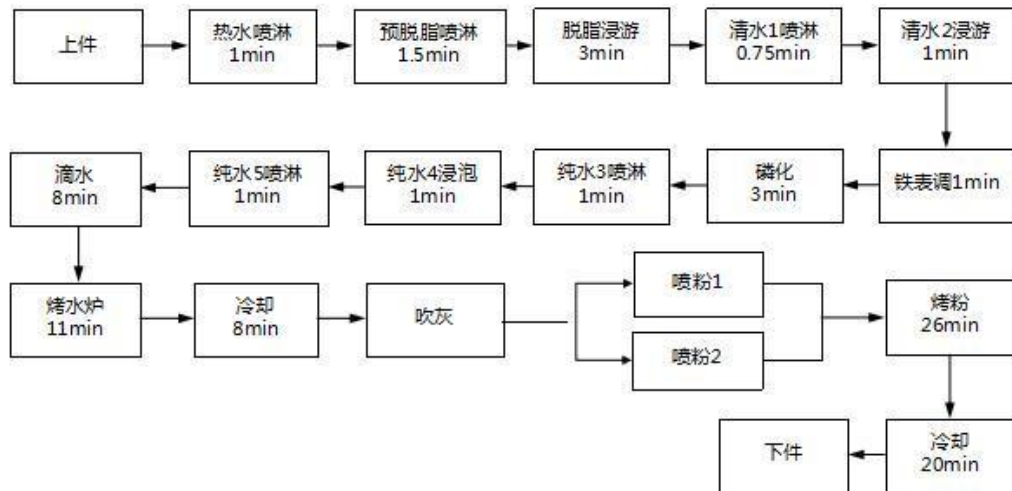
图 2-3 扩建项目粉体线生产工艺流程图
