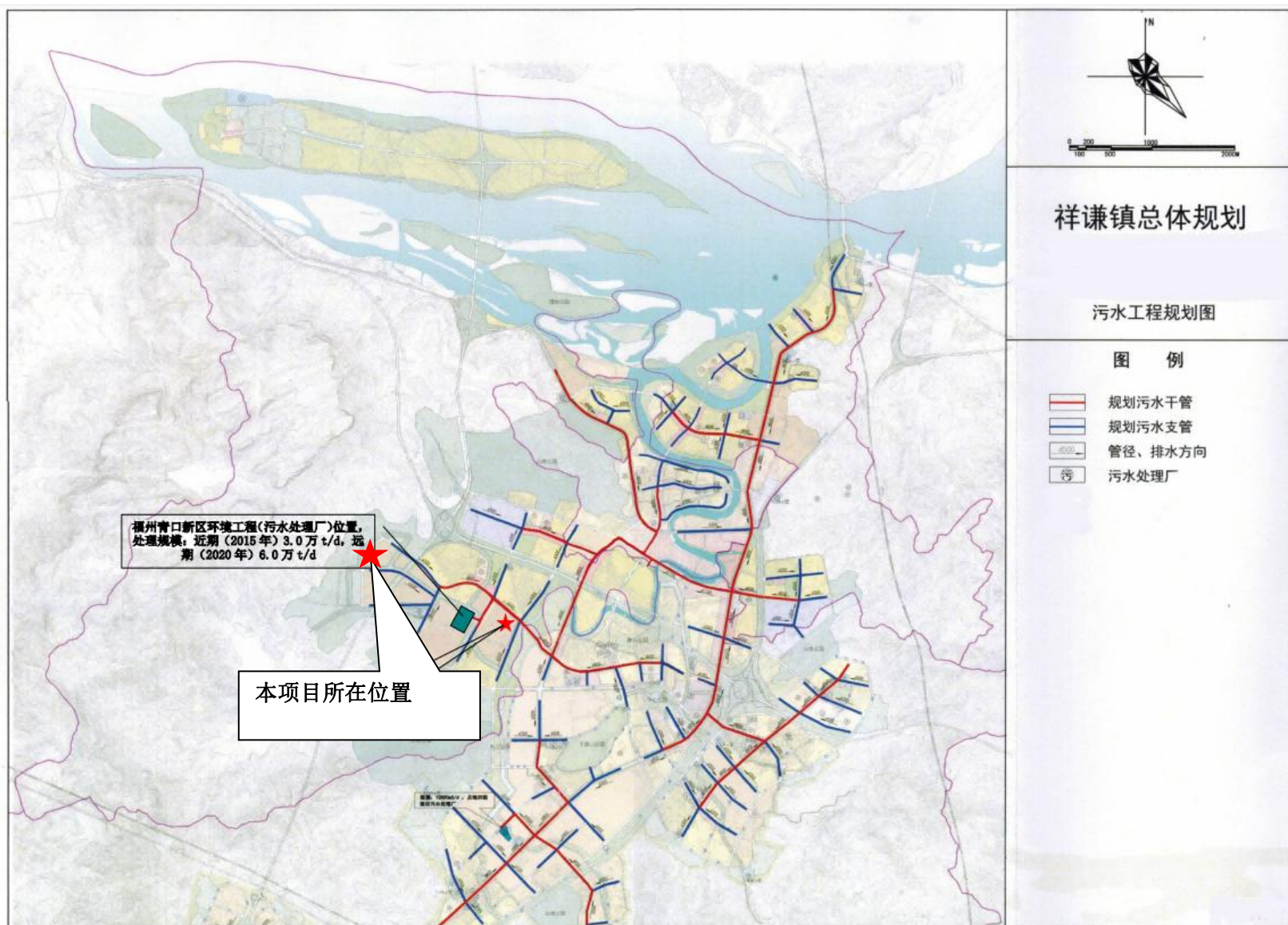
附图 13 项目所在区域污水管网图
