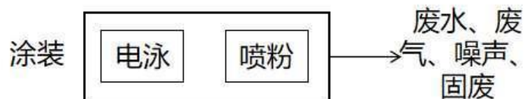
图 2-4 扩建项目涂装产污环节图
