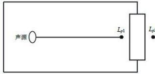
②计算出所有室内声源在靠近围护结构处产生的总倍频带声压级：
