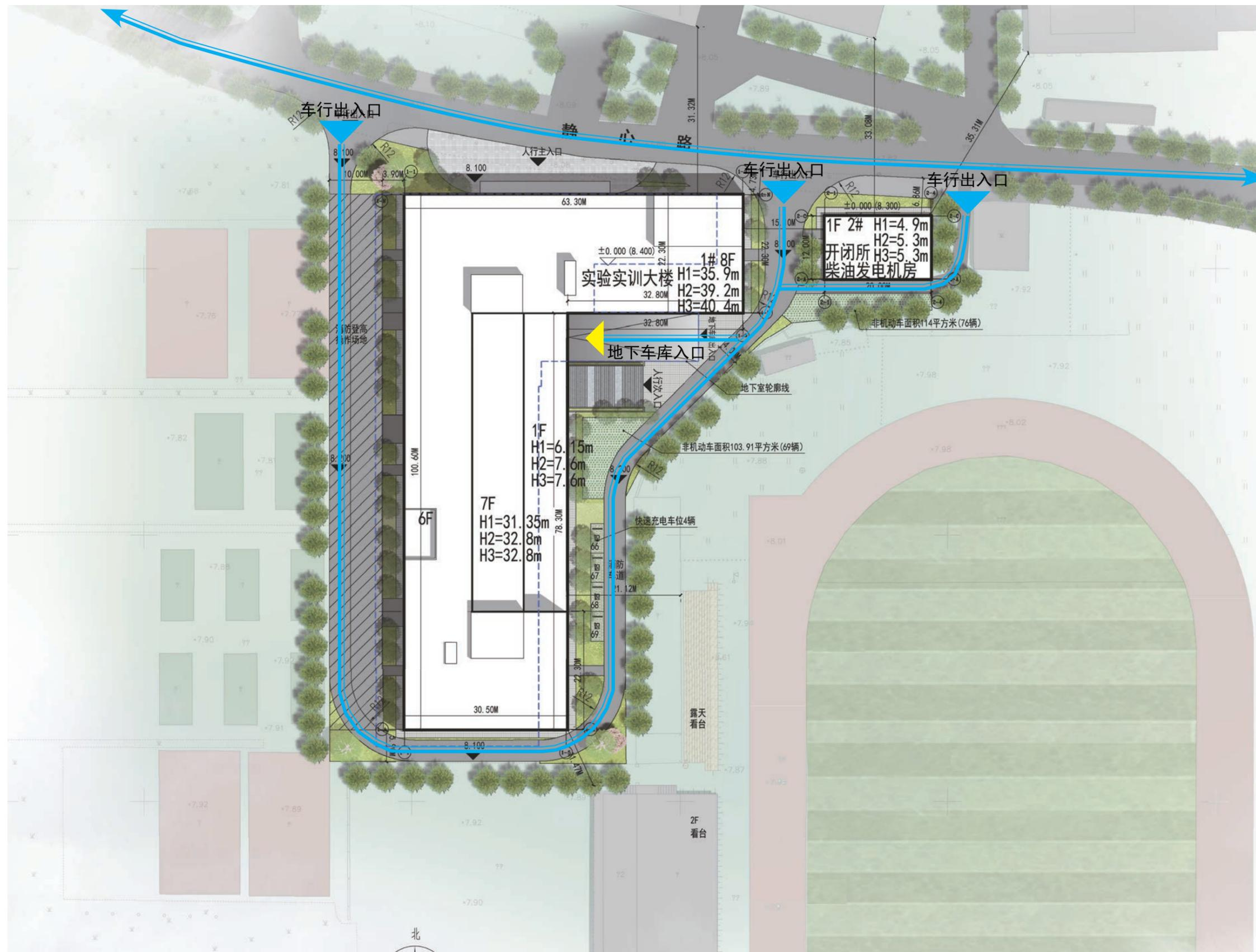
在车行流线上,利用现状地块西侧与篮球场、网球场之间的现状道路,与地块南侧、东侧的新增道路形成环状,方便机动车从静心路进出实验实训中心。同时,将机动车停车场设在负一层,在地块中部设置地下车库出入口。
